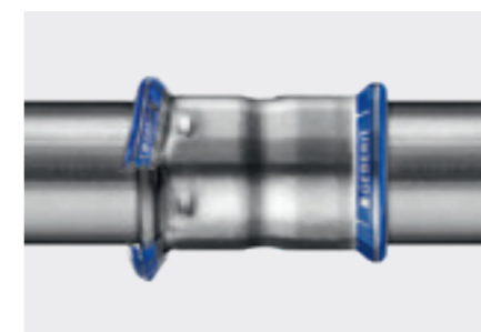
Indicatorii colorați identifică fittingurile Mapress nepresate chiar înainte de testul de presiune.
